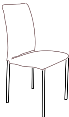
Ø20 Sedia con struttura metallica con tubo da Ø 20 mm / Chair with metal frame and 20 mm tube.
