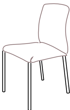
OV Sedia con struttura metallica con tubo ovale da 15x10 mm. / Chair with metal frame and 15x10 mm oval tube.
